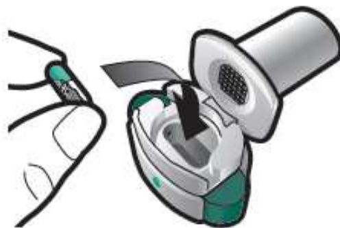
Schritt 1d: Legen Sie die Kapsel ein. Legen Sie niemals eine Kapsel direkt in das Mundstück.
